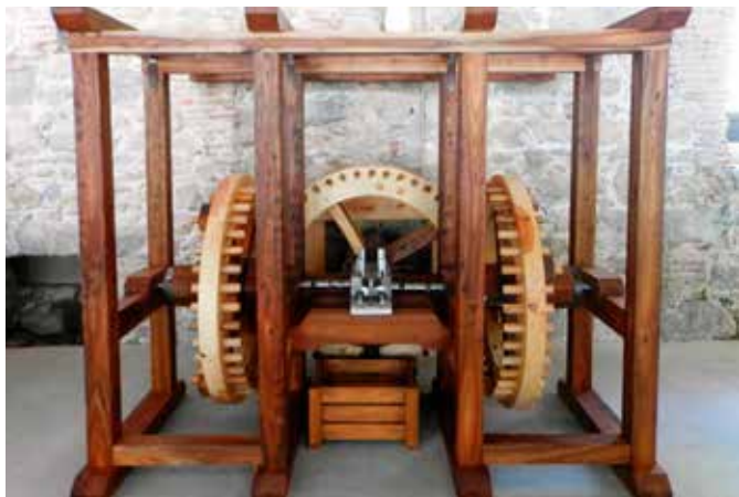
Ingenio de laminar instalado en la Casa de Moneda
